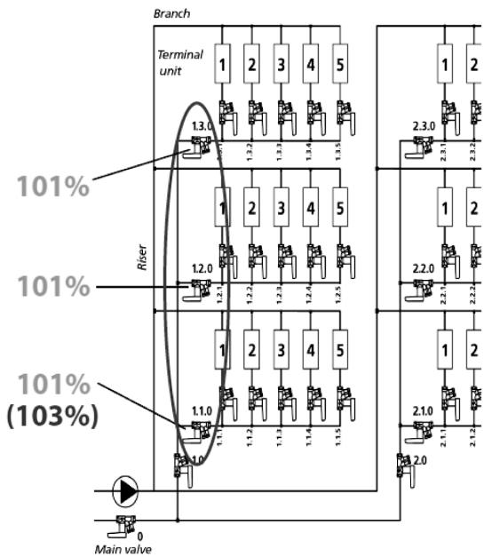
Таким образом, все клапаны на рассматриваемом стояке гидравлически увязаны друг с другом с одинаковым коэффициентом пропорциональности  $\lambda$ . Осуществите аналогичную рассмотренной выше процедуру гидравлической увязки клапанов на стояке со вторым по величине значением  $\lambda$  (в рассматриваемом примере это 2.0.) и т.д. по убыванию.
