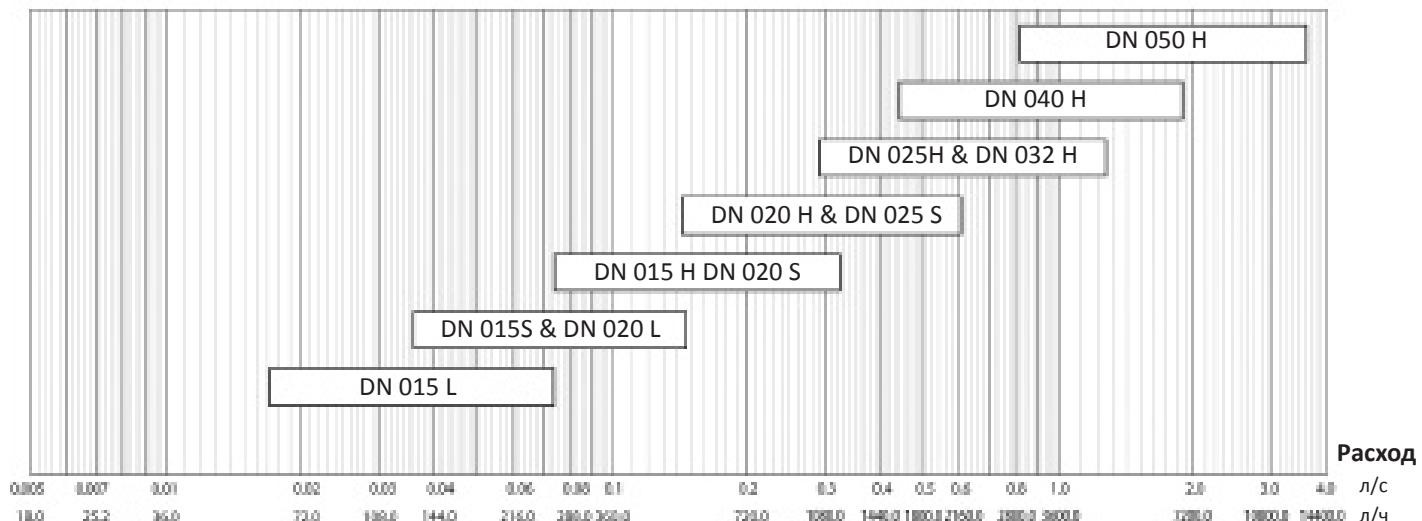
Значения параметра Kv (пропускной способности) для клапанов БРОЕН Venturi FODRV DN 015-050, м<sup>3</sup>/ч:
