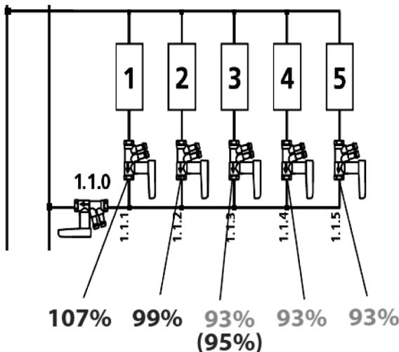
Оставьте первый расходомер в клапане 1.1.5., а второй подключите к клапану 1.1.3. и приведите в соответствие друг с другом значение  $\lambda$  обоих клапанов.
