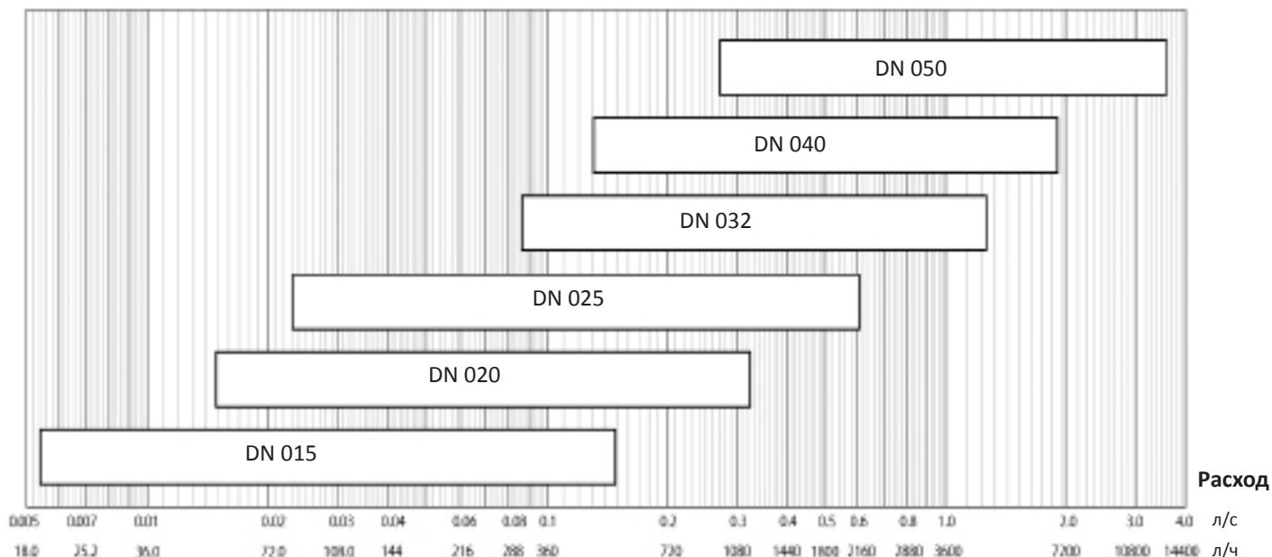
Значение параметра Kv для клапанов БРОЕН V DN 015-050:
