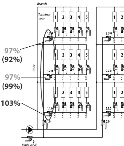
Теперь все клапаны на фанкойлах настроены, переходим к гидравлической увязке клапанов на отводах. Процедура аналогична настройке клапанов на фанкойлах. В нашем примере за Index клапан выбираем клапан 1.3.0. ( $\lambda=92\%$ ). Подключаем первый расходомер к нему, а второй к клапану 1.2.0. ( $\lambda=99\%$ ). Уравниваем значение  $\lambda$  на этих клапанах.
