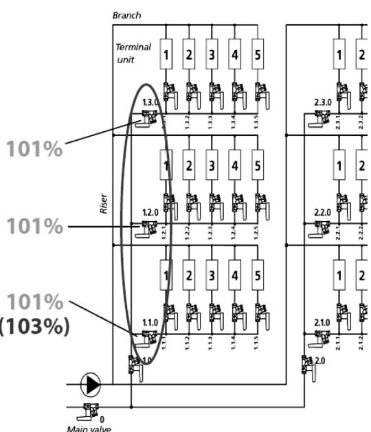
Затем второй расходомер подключаем к клапану 1.1.0. и приводим в соответствие друг другу значения  $\lambda$  для клапанов 1.3.0. и 1.1.0.
