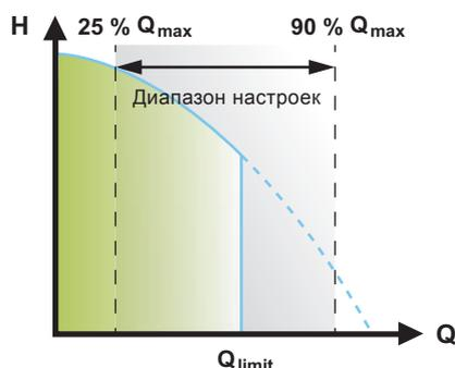
Рис. 27 FLOW<sub>LIMIT</sub>
