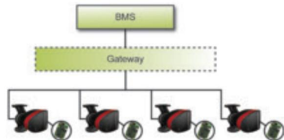
Рис. 8 Пример системы управления внутридомовыми коммуникациями (BMS)
