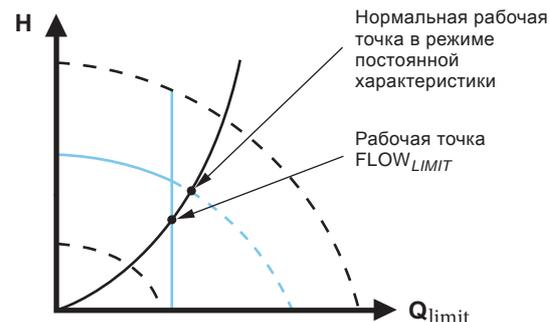
Рис. 30 Режим постоянной характеристики с функцией FLOW<sub>LIMIT</sub>
