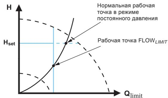
Рис. 29 Регулирование по постоянному давлению с функцией FLOW<sub>LIMIT</sub>
