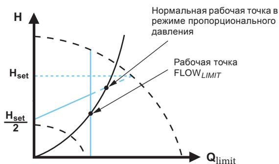
Рис. 28 Регулирование по пропорциональному давлению с функцией FLOW<sub>LIMIT</sub>
