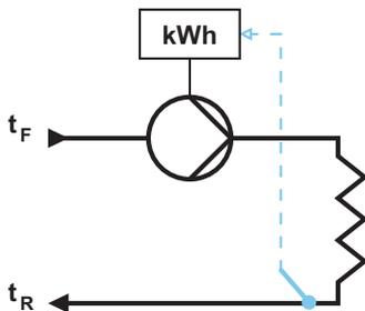
Рис. 37 Насос MAGNA3 со встроенным счетчиком тепловой энергии.
