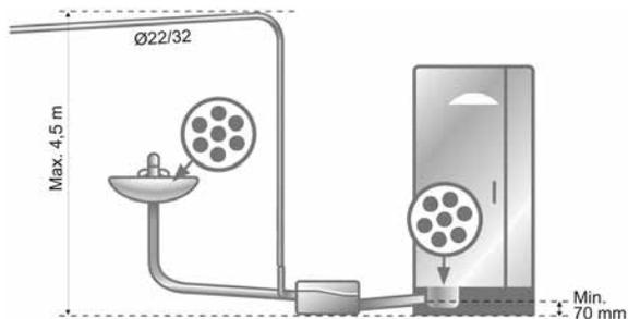
Рис. 51. Для раковины и душевой кабины (Sololift2 D-2)
