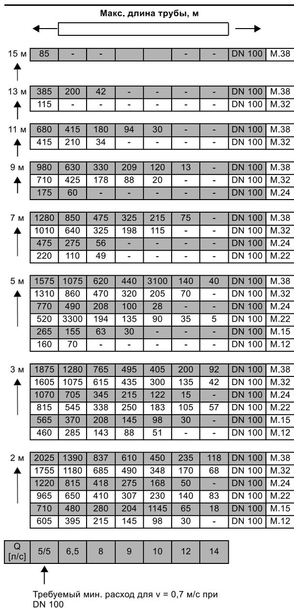
Рис. 103. Максимальная длина вертикальных или горизонтальных напорных трубопроводов
