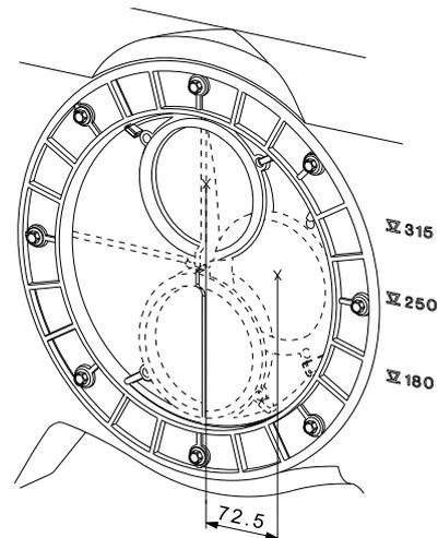
Рис. 108. Основное впускное отверстие с эксцентрическим диском
