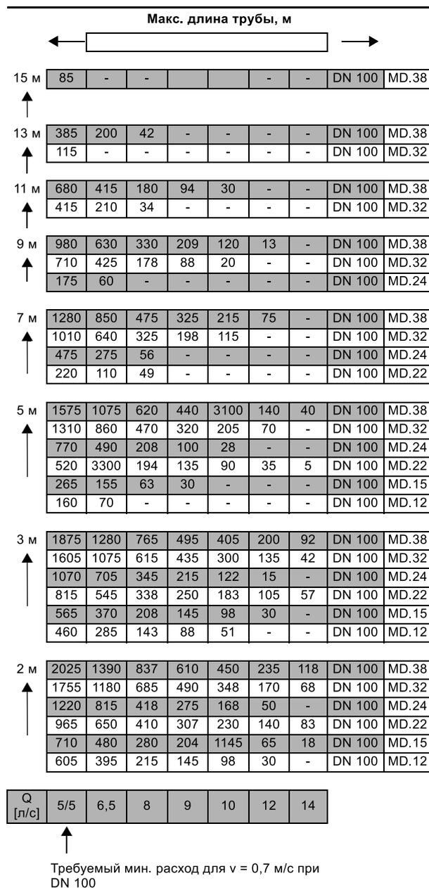
Рис. 98. Максимальная длина вертикальных или горизонтальных напорных трубопроводов
