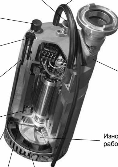
Одноступенчатый моноблочный насос с вертикальным напорным патрубком и приемным сетчатым фильтром. Компактная конструкция позволяет использовать насос в узких колодцах и ямах. В стандартное исполнение насоса DW входят стандартные встроенные электроды и 20-метровый кабель. Исполнение без электродов также возможно. В этом случае для насоса необходимо внешнее управление.
