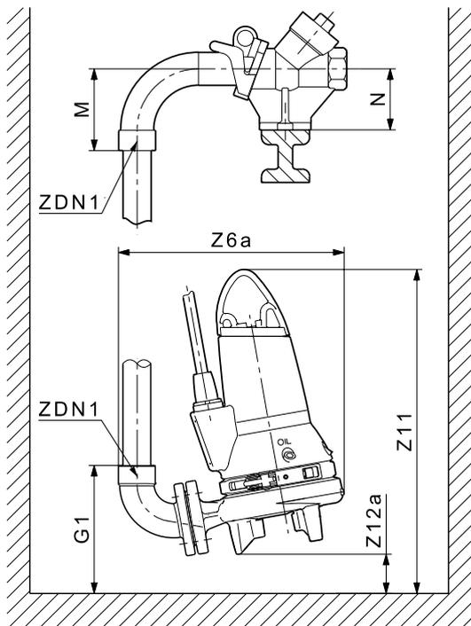
Установка на автоматической трубной муфте
