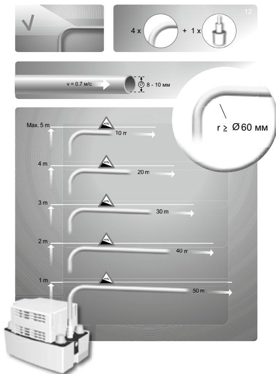
Рис. 73. Максимальная длина вертикального и горизонтального напорных шлангов
