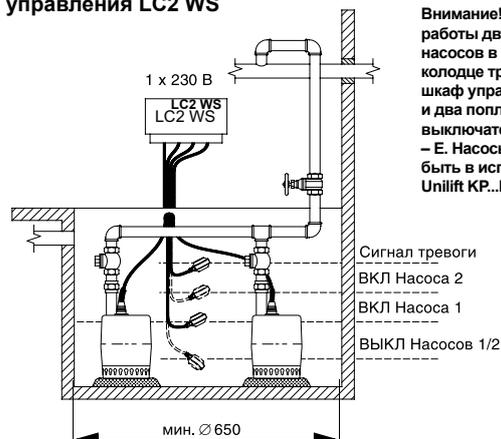
Внимание! Для работы двух насосов в одном колодце требуются шкаф управления и два поплавковых выключателя Reifa – E. Насосы должны быть в исполнении Unilift KP...M1
