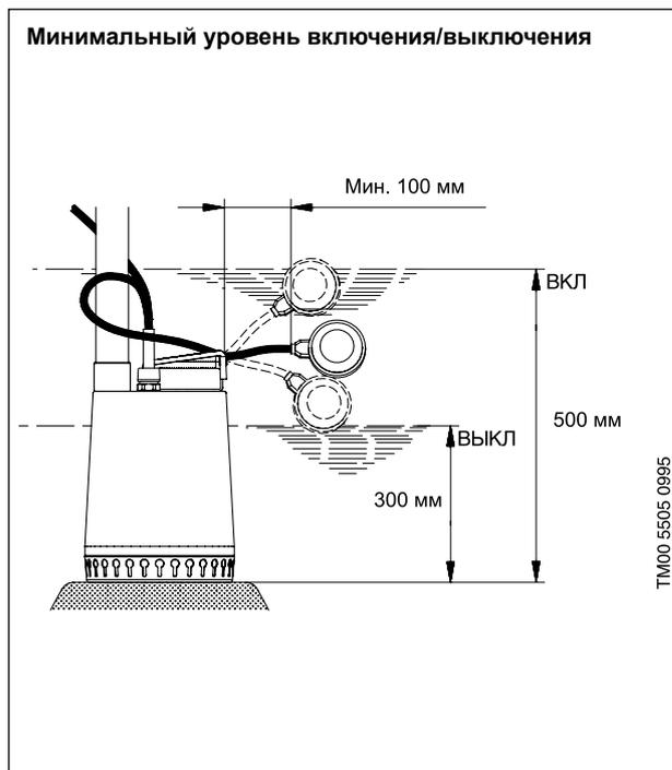
**Примечание.** Допускается монтаж насоса в горизонтальном или наклонном положении. При этом напорный патрубок должен быть расположен в верхней точке, уровень воды – всегда выше приемной сетки насоса.
