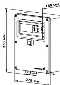
Рис. 123. Габаритные размеры
