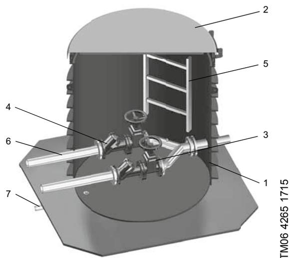
Рис. 149. Камера переключения
