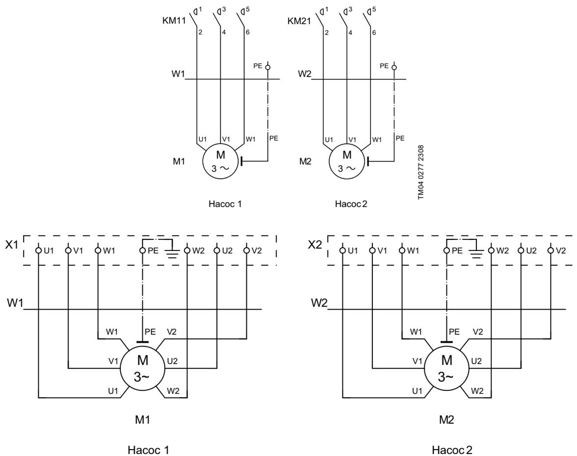
Рис. 127. Схема подключения сигнальных кабелей шкафа управления для работы в полностью автоматическом режиме
