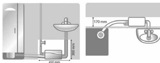
Рис. 52. Для раковины и душевой кабины (Sololift2 D-2)
