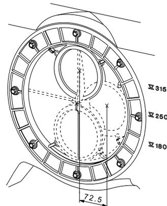
Рис. 94. Основное впускное отверстие с эксцентрическим диском
