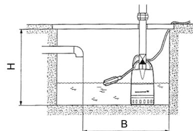
**Примечание.** Допускается монтаж насоса в горизонтальном или наклонном положении. При этом напорный патрубок должен быть расположен в верхней точке, уровень воды — всегда выше приемной сетки насоса.
