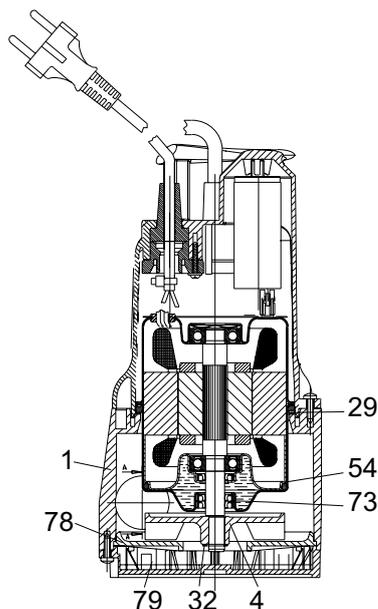
Рис. 33. Разрез насоса KPC A и KPC 24/7
