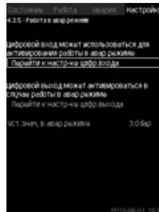
Рис. 32 Работа в аварийном режиме
