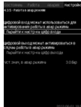
Рис. 32 Работа в аварийном режиме
