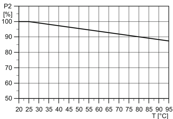
Рис. 20 Соотношение мощности двигателя (P2) и температуры окружающего воздуха
