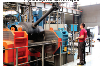
Тестирование шаровых кранов
