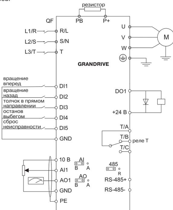
Рис. 8. Схема подключения ПЧ
