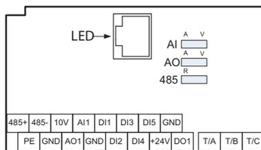
Рис. 10. Принципиальная схема расположения элементов цепи управления
