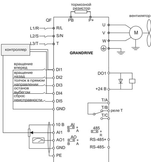
Рис. 2. Схема подключения вентилятора
