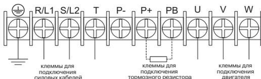
Рис. 9. Схема подключения силовой цепи преобразователя частоты
