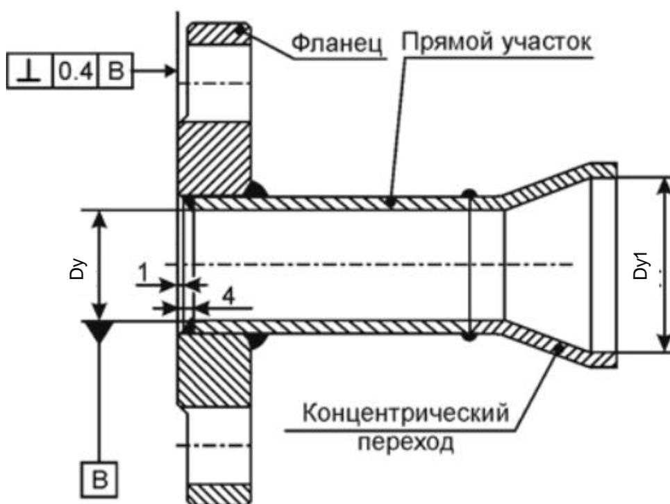
Рисунок 6 - Требования к точности установке фланцев
