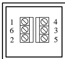
Назначение контактов для клеммных коробок типа 4
