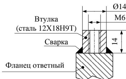
**Монтаж фланцевого первичного преобразователя на трубопровод**
