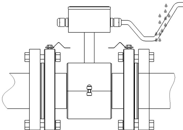
Подключаемые кабели должны иметь вид «U-петли», чтобы вода, попадающая на провода, не проникала на электронный блок (см. рис.14).
