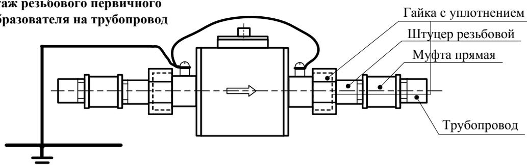
Рисунок 7 – Монтаж первичных преобразователей на трубопровод
