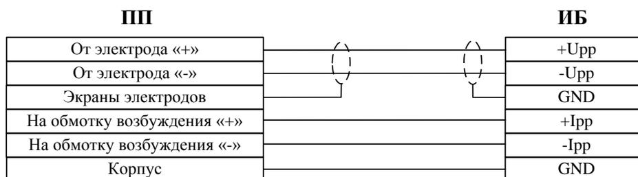
Рисунок 13- Распайка соединительного кабеля
